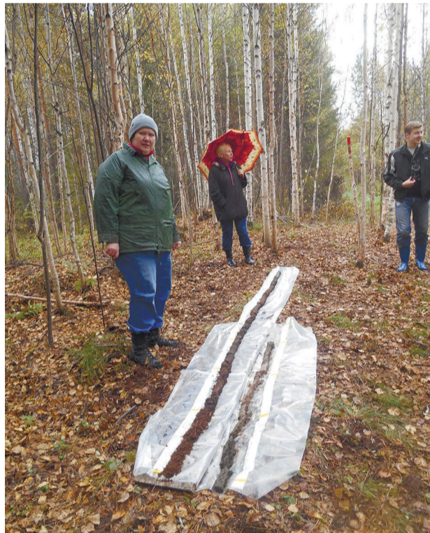
Керн, отобранный буром на Горбуновском торфянике. Общая мощность отложений 4,5 м (3 м – сапрпель и 1,5 м – торфа).
